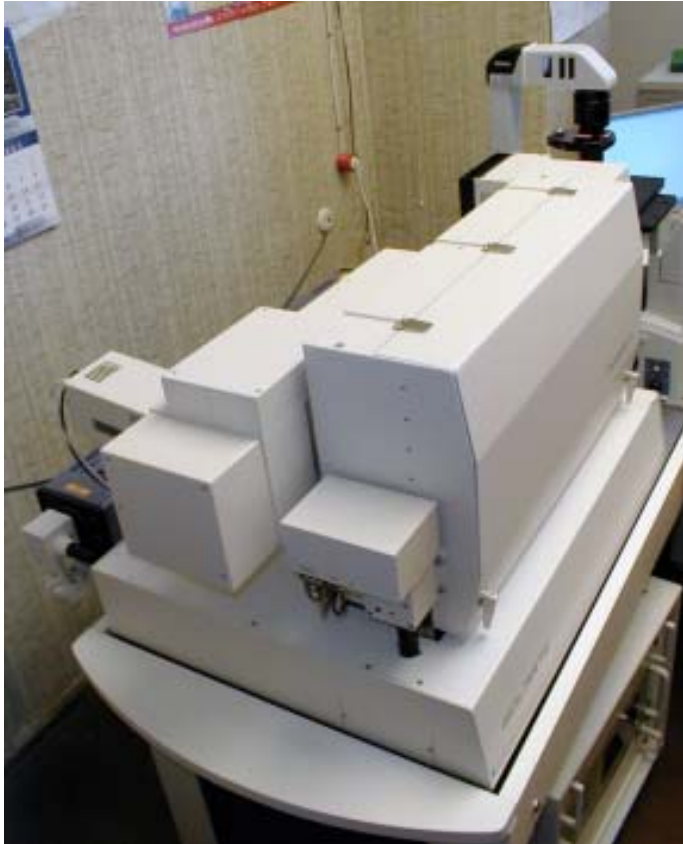
3D skenējošais konfokālais mikroskops ar spektrometru; optiskā izšķiršana 200 nm
