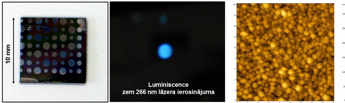
2.att. Luminiscējošs testa paraugs ZnWO 4 plānās kartiņas bāzē un tā AFM 18×18 μm attēls.
